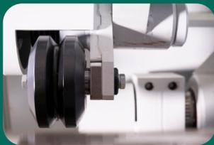
Der neue Schnellwechsel reduziert die Rüstzeit um 80%. Mit dem Schnellwechsel können Bediener die Drahtrelaxierrollen einfach und sicher wechseln, ohne die Jochbaugruppe zu entfernen oder Spezialwerkzeug zu benutzen. Außerdem müssen keine Wartungsteams mehr in den Prozess einbezogen werden.
