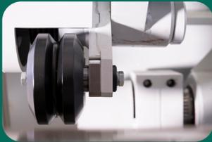
Il nuovo sistema di sostituzione rapida Quick Change riduce dell'80% il tempo di allestimento della sostituzione. Questo sistema consente agli operatori di sostituire i rulli svolgitori agevolmente e in tutta sicurezza, senza rimuovere il gruppo della forcella e senza attrezzi speciali. Inoltre non sarà più necessario coinvolgere specifici team di manutenzione in questo processo.
